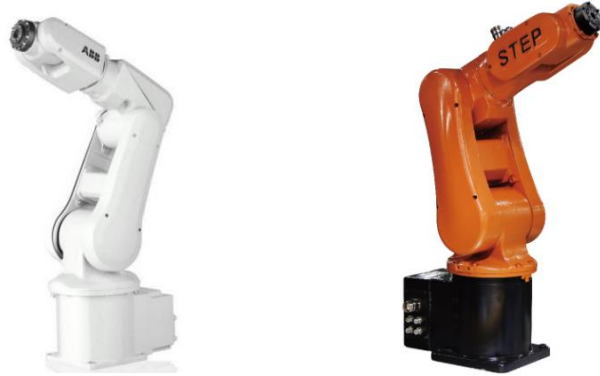
图 3 桌面型小负载串联关节六自由度工业机器人
