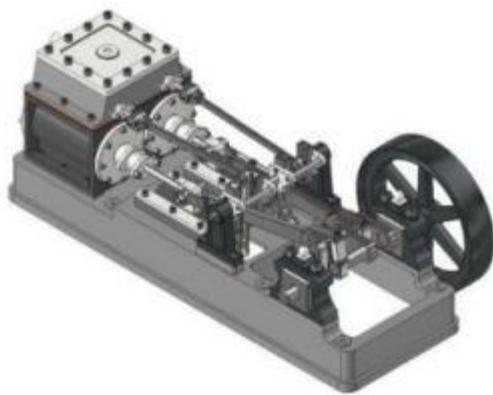
图 1-2 复合式双缸蒸汽机
