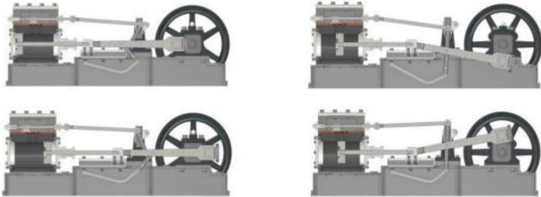
图 1-3 复合式双缸蒸汽机主要机构
