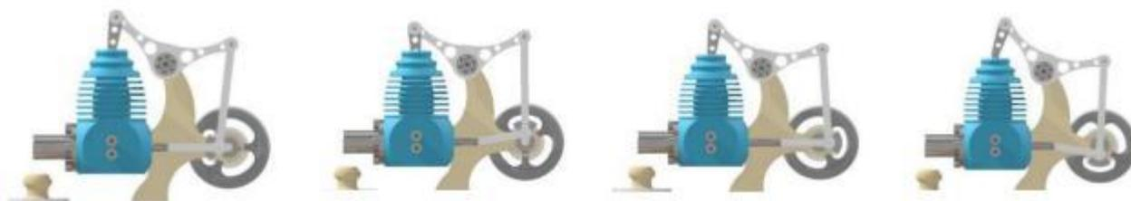
图 1-3 斯特林发动机气缸工作原理
